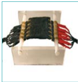
K 55 Kleine Kelvin Messzange mehrfach Integrale Kelvinmessung an leitenden Stoffen
